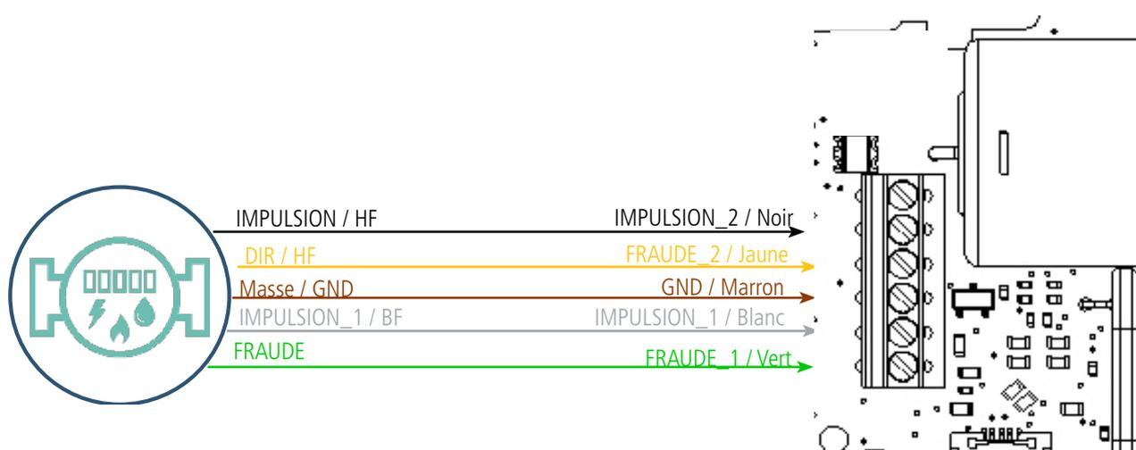
Dans cette configuration, les 2 voies (A et B) doivent être activées (registre 320 bit 0 et 4 mis à 1). La combinaison des comptages d'impulsions sur les voies A et B (IMPULSION\_1 et IMPULSION\_2) permettent de connaître les quantités passées dans les 2 sens. L'activation des signaux FRAUDE\_1 et FRAUDE\_2 (registre 320 respectivement bit 3 et 7 mis à 1) permet de générer des alarmes de fraude et de mauvais sens de circulation.
