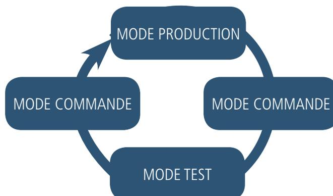
Le retour au mode d'exploitation se fait par la commande ATO ou débranchement du câble USB
